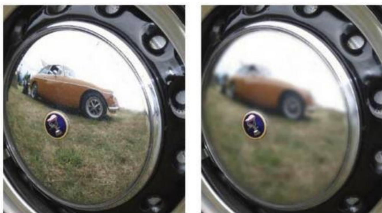
雾影是涂料和抛光材料中普遍存在的问题。它会使物体表面形成乳状外观，从而降低成像清晰度。Rhopoint IQ Flex 60 能迅速检测出产品表面是否存在雾影现象。
