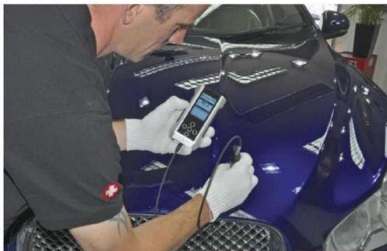
雾影是涂料和抛光材料中普遍存在的问题。它会使物体表面形成乳状外观，从而降低成像清晰度。Rhopoint IQ Flex 60 能迅速检测出产品表面是否存在雾影现象。
