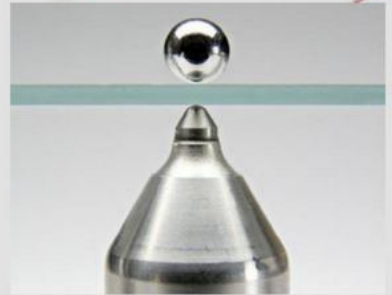
参考钢珠有一个特殊的涂层处理和尺寸精度以获得读数的最大限度重现性。
